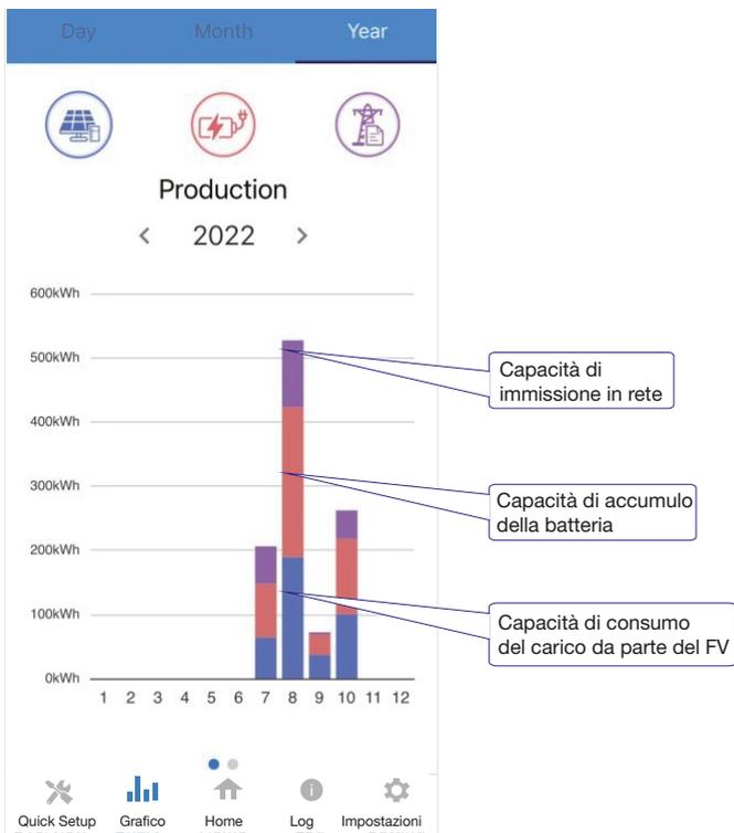
Il grafico dell'anno combinato mostra la distribuzione della capacità di produzione fotovoltaica in tre parti:
