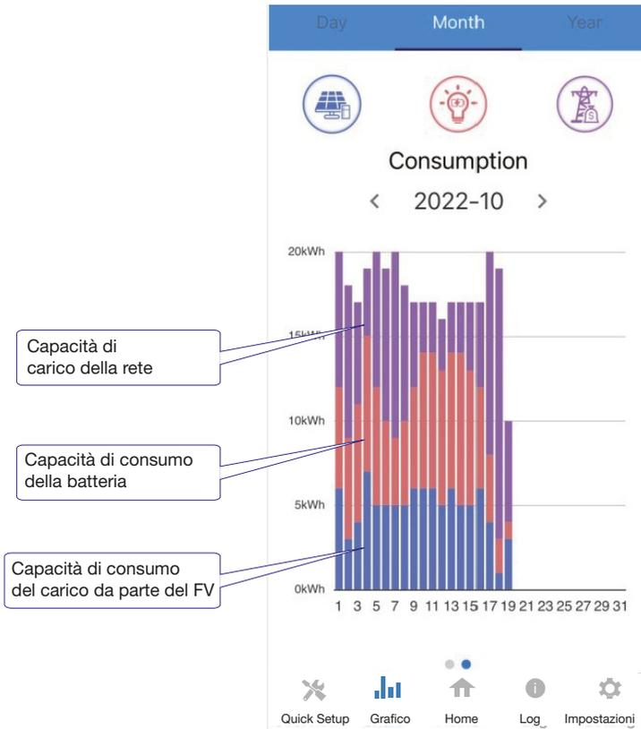
Il grafico della combinazione di mesi di cui sopra mostra la capacità di consumo del carico da tre parti:
