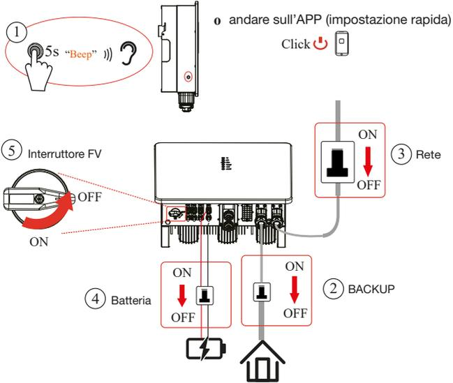
Dopo lo spegnimento dell'Inverter, l'elettricità e il calore residui possono ancora causare scosse elettriche e ustioni al corpo. Se è necessario scollegare i cavi dall'inverter, attendere almeno 10 minuti prima di toccare queste parti dell'Inverter.
