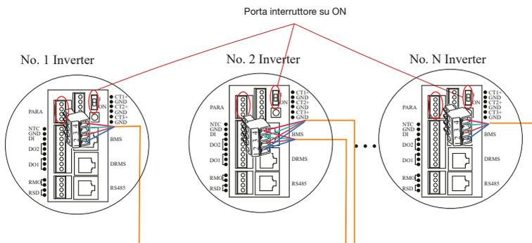
È necessario portare su “ON” l’interruttore della resistenza di accoppiamento dell’inverter n. 1 e dell’inverter n. N in modalità di collegamento in parallelo.
